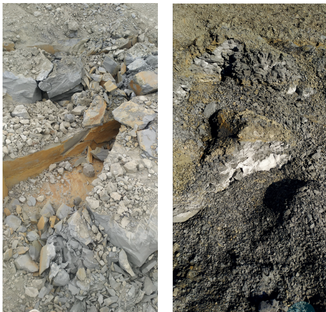
Obrázek 2: Ztráta pevnosti a rozpad horniny po třech měsících po působení klimatických vlivů v rámci stavby D35 Časy–Ostrov; 27. 8. 2020 – fotografie vlevo, 24. 11. 2020 – fotografie vpravo
