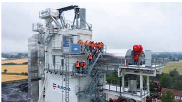
Obrázek 1: Obalovna Ammann APB vybavená technologií RAH 100 (Eurovia, Německo)
