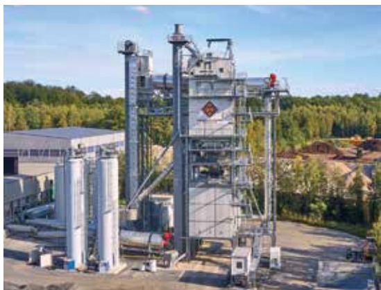
Obrázek 1: Obalovna Ammann APB vybavená technologií RAH 100 (Eurovia, Německo)
