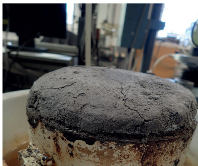
Obrázek 7: Vzorek ložového popela z Teplárny Kladno po zkoušce lineárního bobtnání při vlhkosti w = 20\%
