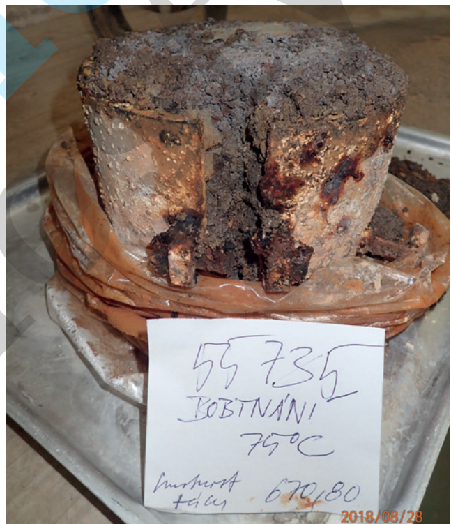
Obrázek 10: Roztržený moždíř CBR s nahutněnou ocelářskou struskou s příměsí hutní keramiky ze sondy KS11 (hl. 1,0 m) z obchodního centra TESCO Ostrava Třebovice po 350 dnech zkoušení
