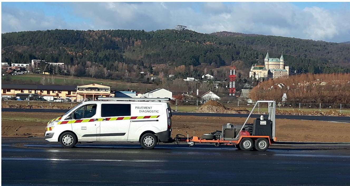
Obrázok 7: Meranie únosnosti zariadením FWD (letisko Prievidza)
