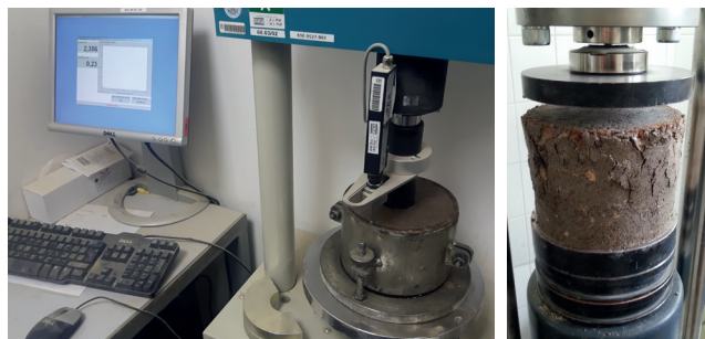
Obrázok 1: Skúšobné telesá (vľavo – pri skúške IBI; vpravo – pri skúške pevnosti v tlaku)
